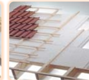
S-GD Dämmung auf einem unverschalteten Dach
